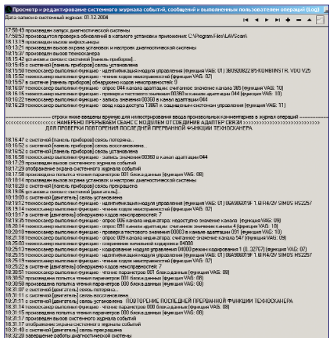
Рис. 7 Журнал операций LAVScan позволяет диагносту полностью контролировать как свои действия, так и действия системы
