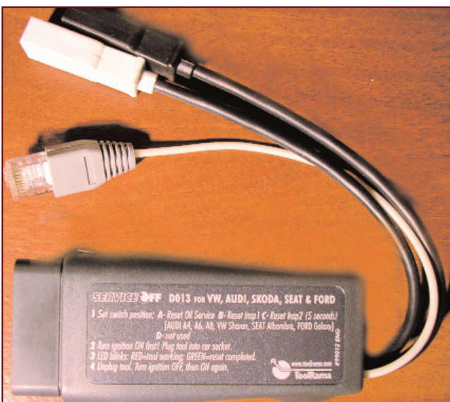
Рис. 1. VAG-адаптер связи, совмещенный с ключом сброса сервисных интервалов ТО
