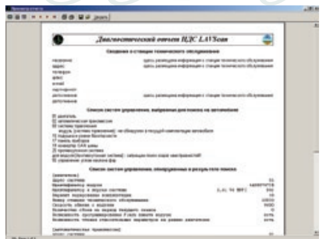
Пример диагностического отчёта ИДС LAVScan. В области сведений о станции технического обслуживания содержатся те данные, которые были предварительно введены в аналогичные поля экрана настроек на странице «Отчёт».
