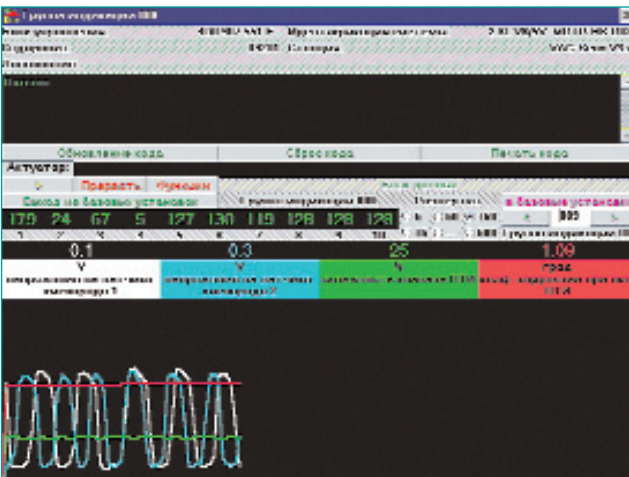
Рис. 4. Сканер диагностической системы VAG-Scan в режиме отображения четырех абсолютных параметров блока 9 (функция 08)
